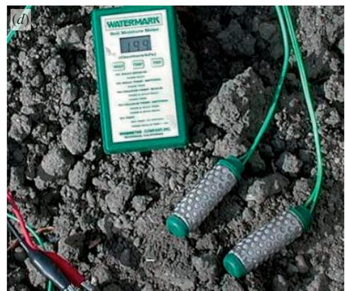
**FIGURA 10.1.2** Blocchetti di Bouyoucos: (a) Schema; (b) blocchetti di gesso; (c) apparecchiatura per il rilievo dell'umidità del suolo; (d) sensori Watermark contenuti in maglie di acciaio inox per prolungarne la funzionalità (fonte: ISU Extension and Outreach).
